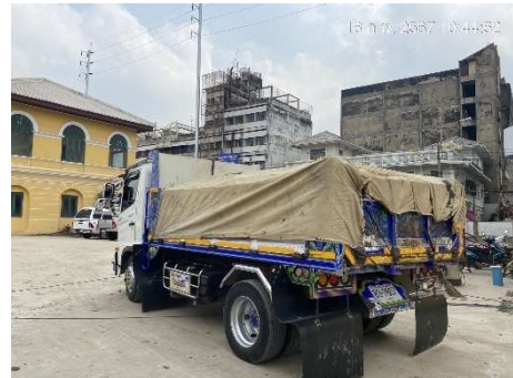
รูปที่ 10 ปิดคลุมผ้าใบกระบะรถบรรทุกขนดินให้มิดชิดก่อนออกจากพื้นที่ก่อสร้าง
