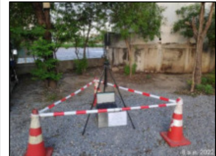
การตรวจสอบระดับเสียง
